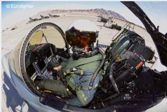
Abb. 2: Die hohe Sitzposition des Piloten im Eurofighter ermöglicht eine gute Rundumsicht, verlangt aber Dreh- und Nickbewegungen des Kopfes - auch unter hohen g-Belastungen. Informationen werden akustisch und visuell bereitgestellt. Dem Piloten stehen ein Head-up-Display, drei Head-down-Displays, ein Warning Panel und ein Helmet Mounted Symbology System zur Verfügung. Die Performance des Gesamtsystems ist damit unmittelbar von den körperlichen (insbesondere Belastung der HWS, Seh- und Hörvermögen) und auch psychischen Leistungsfähigkeiten (Signalerkennung und -verarbeitung, Multitasking) abhängig. Aufgabe von HPO ist es u.a., hierfür spezifische Trainingsverfahren zu entwickeln.
