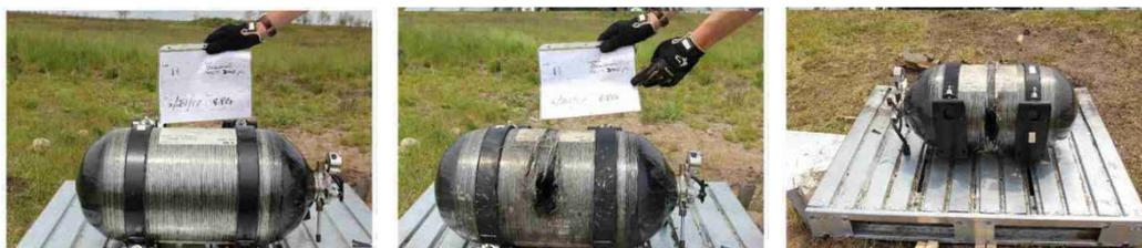
**Abb. 6:** Simulierter Beschuss eines Wasserstoffdrucktanks durch eine RPG; von links nach rechts: (1) Vor dem Beschuss; (2) Nach dem Beschuss: Eintrittsloch; (3) Nach dem Beschuss: Austrittsloch (Paczkowski 2018: 161)
